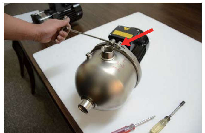
步驟19:用六角扳手將束帶鎖上,組裝完成
