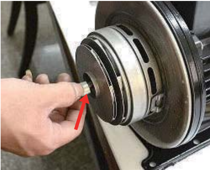
步驟10:放入夾緊套管
