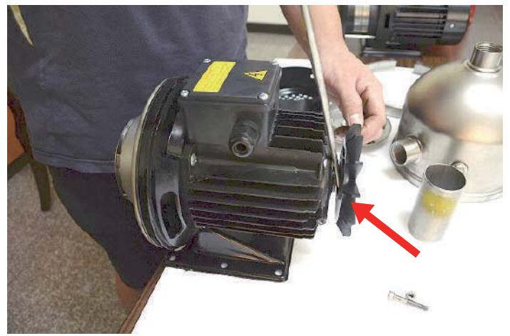
步驟7:用扁形起子將風扇像外扳，取下風扇
