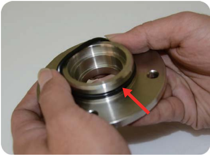
步驟6:軸封固定座套上O型環(AS568-123)
