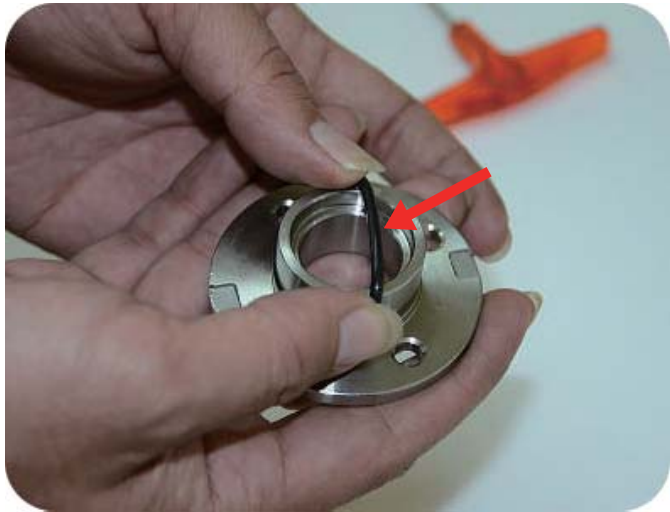
步驟6:軸封固定座套上O型環(AS568-121)
