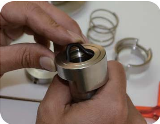
步驟9:將心軸內的O型環(AS568-114)取出 *建議使用工具輔助
