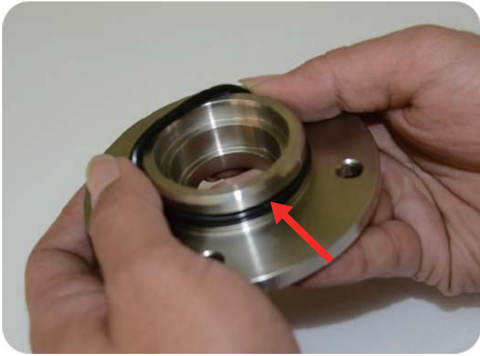
步驟6:軸封固定座套上O型環(P44)
