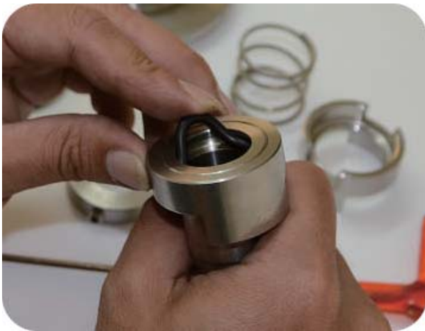
步驟9:將心軸內的O型環(P12)取出 *建議使用工具輔助
