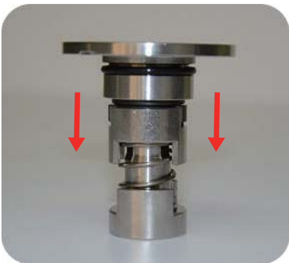
步驟9:心軸放上軸封固定座
