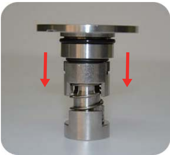
步驟9:心軸放上軸封固定座
