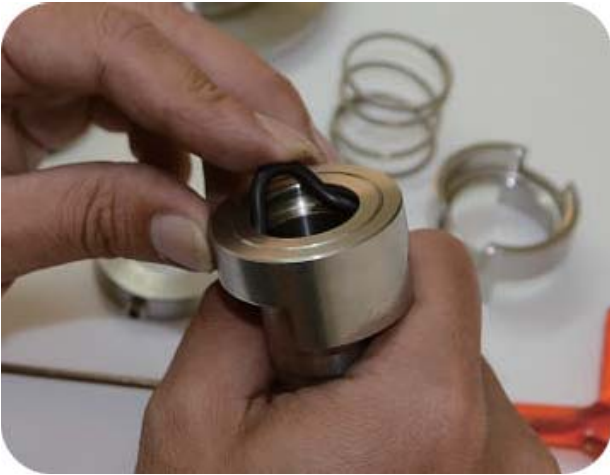
步驟9:將心軸內的O型環(P22A)取出 *建議使用工具輔助
