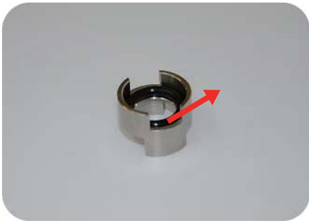
步驟7:將護套內的O型環(AS568-208)取出
