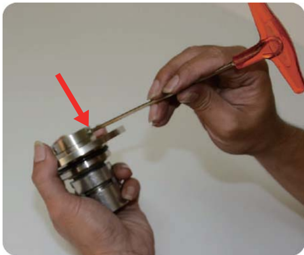
步驟1:使用2.5mm六角扳手將螺栓轉出
