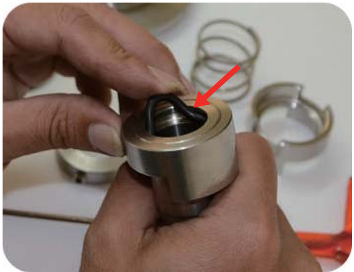
步驟1:將O型環(P12)放入心軸凹槽內
