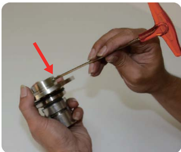
步驟1:使用2.5mm六角扳手將螺栓轉出
