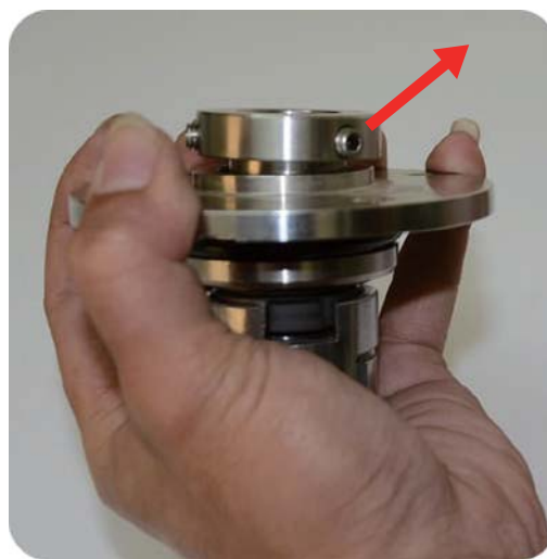
步驟2:握緊軸封固定座，避免零件彈開 螺栓轉開即可，不必取出 將六角承窩頭取下
