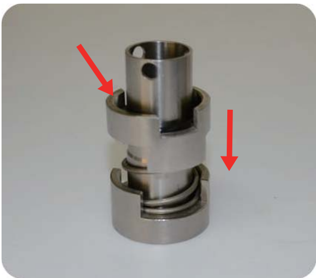
步驟4:將護套套入心軸
