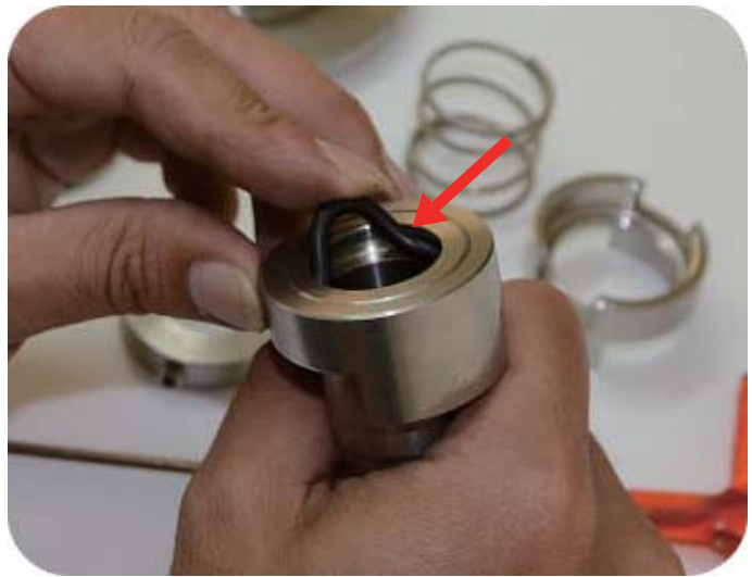
步驟1:將O型環(AS568-114)放入心軸凹槽內
