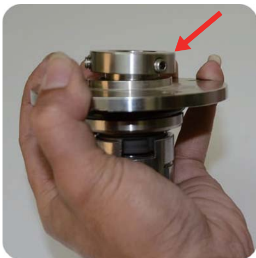
步驟11:握緊軸封固定座，放上六角承窩頭
