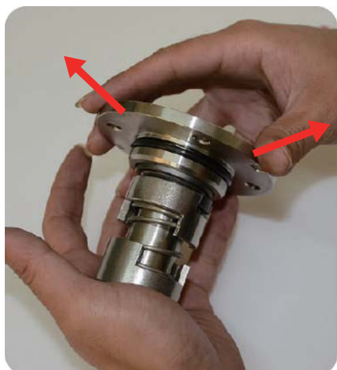
步驟3:取下軸封固定座
