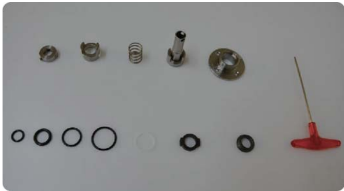
組裝SB-1,2,3,4,5 SBI-1,2,3,4,5 機型軸封 需準備2.5mm六角扳手
