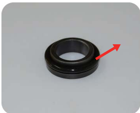
步驟3:將墊圈取出 取下軸封固定座
