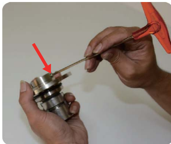
步驟12:使用2.5mm六角扳手將螺栓鎖入 但不得將螺栓鎖入超出心軸 螺栓不凸出六角承窩頭即可
