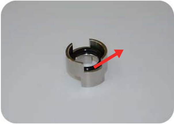
步驟7:將護套內的O型環(P26)取出
