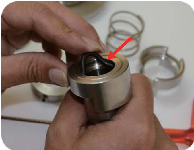
步驟1:將O型環(P22A)放入心軸凹槽內
