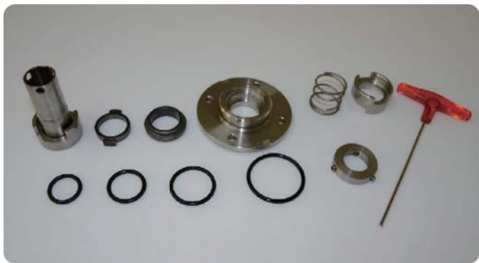
組裝SB-32,45,64,90 機型軸封 需準備3mm六角扳手
