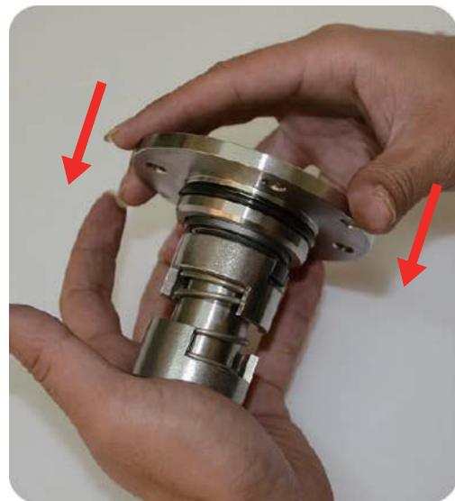
將軸封固定座下壓並緊握，避免上鎖螺栓時彈開
