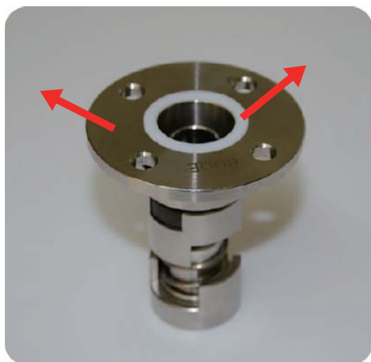
步驟3:將墊圈取出 取下軸封固定座
