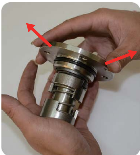
步驟3:取下軸封固定座
