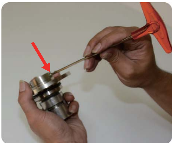
步驟1:使用3mm六角扳手將螺栓轉出
