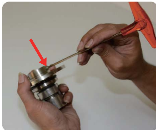
步驟12:使用3mm六角扳手將螺栓鎖入 但不得將螺栓鎖入超出心軸 螺栓不凸出六角承窩頭即可
